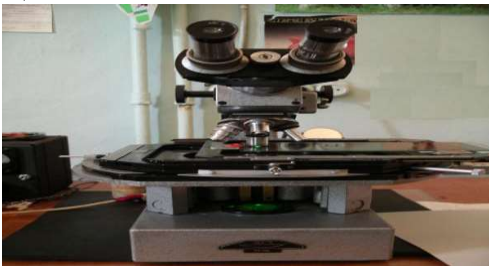
4-rasm. Mikroskop MBI-9 ning tashqi ko'rinishi.
