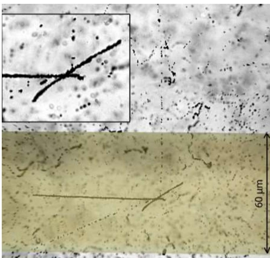
Рис. 2. Мозаичная макрофотография «молоточкового» распада ядра  $^8\text{He}$ , остановившегося в ядерной эмульсии (горизонтальный след). В распаде образовались пара релятивистских электронов (точечные следы) и пара  $\alpha$ -частиц (короткие противоположно направленные следы). На вставке сверху представлена увеличенная вершина распада. Для иллюстрации пространственного разрешения образ распада совмещен с макрофотографией человеческого волоса толщиной 60  $\mu\text{m}$ .
