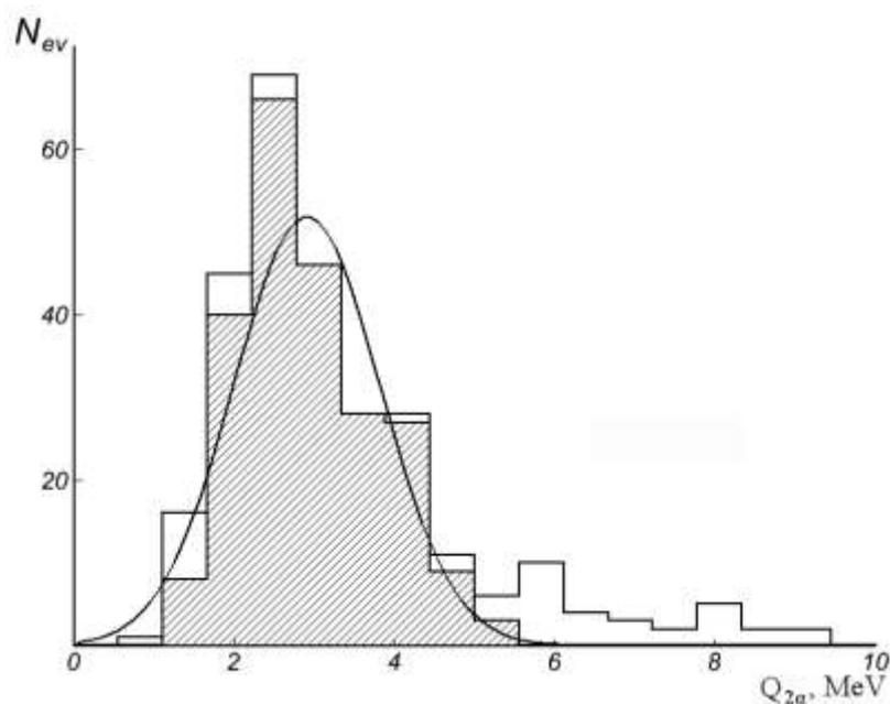
Рис. 12. Распределение по энергии  $Q_{2\alpha}$  пар  $\alpha$ -частиц; заштрихованная гистограмма отвечает условиям отбора событий  $L_1$  и  $L_2 < 12.5 \mu\text{m}$ ,  $\Theta > 145^\circ$ ; линия - функция Гаусса.
