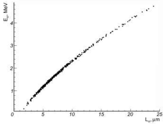
Рис. 9. Определение энергии  $\alpha$ -частиц по измеренным пробегам.
