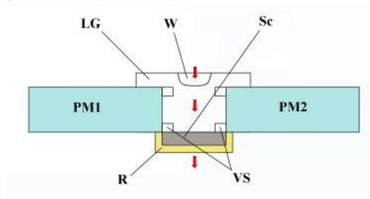
Рис. 4. Схема сцинтилляционного детектора для измерения времени пролета фрагментов на прямолинейном участке F3-F4 сепаратора ACCULINNA. Обозначения: W – входное окно для пучка, закрытое отражателем, LG – полый диффузный световод, Sc – сцинтиллятор, PM1,2 – фотоумножители, R – отражатель, VS – вакуумные уплотнители.
