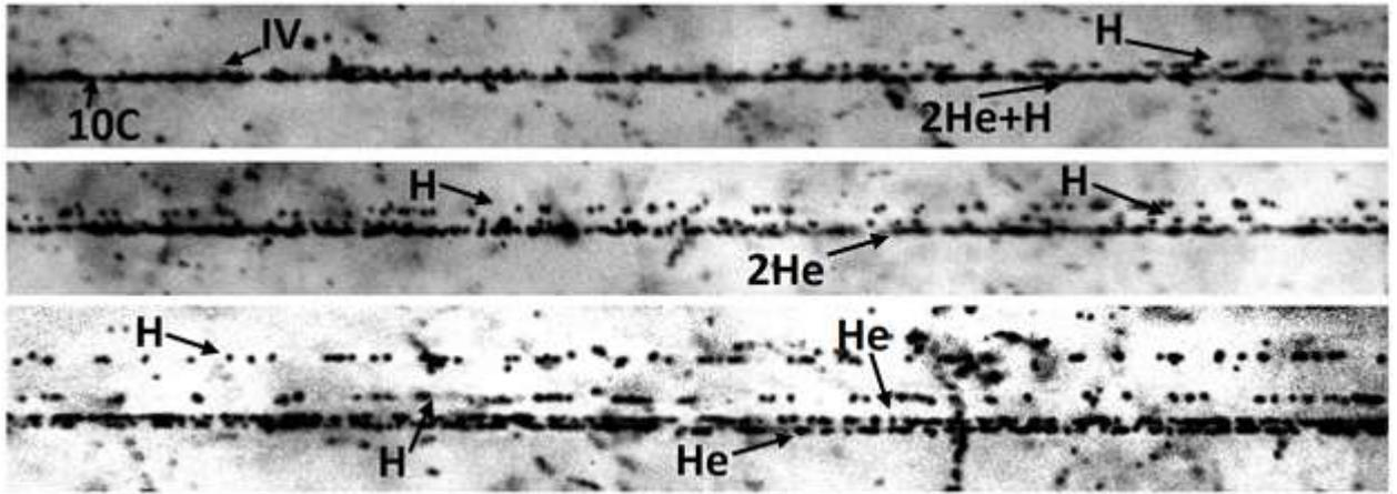
Рис. 3. Микрофотография «белой звезды»  $^{10}\text{C} \rightarrow 2\text{He} + 2\text{H}$ . На верхней фотографии видна вершина диссоциации (IV) и струя фрагментов в узком конусе; при продвижении вдоль струи различаются релятивистских фрагменты He и H.
