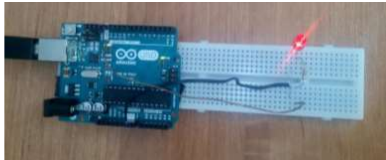
3-rasm. “ Arduino UNO ” qurilmasini yigilgan sxemaga ulash.
